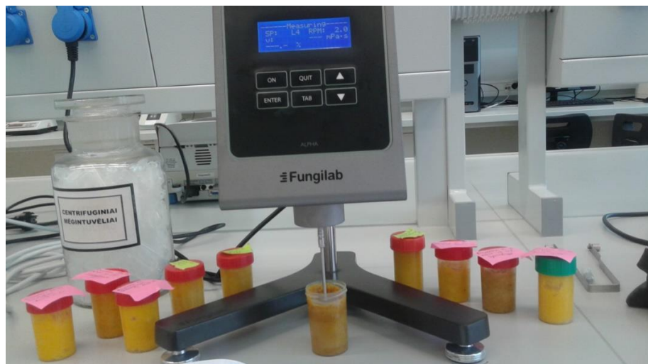
4 pav. Klampos matavimas viskozimetru „Fungilab Alpha“
