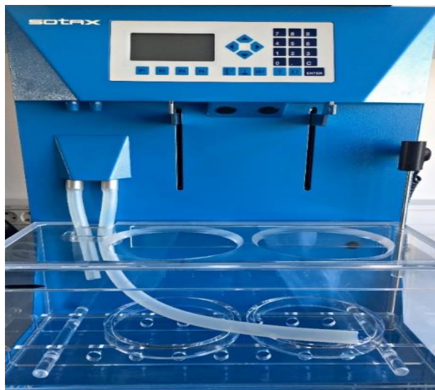
2pav. Suirimo testui nustatyti naudojamas prietaisas „Sotax”
