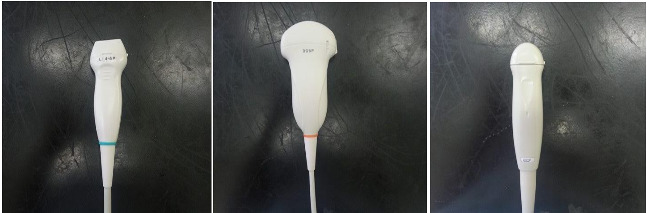
2 pav. Linijinis jutiklis (kairė), konveksinis jutiklis (viduryje) ir mikrokonveksinis jutiklis (dešinėje)
